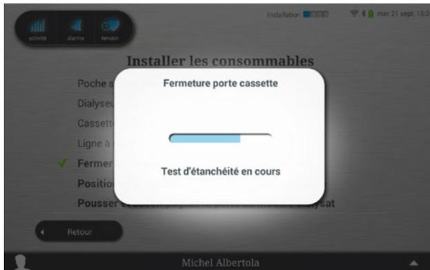
Une fois la porte verrouillée, une série de tests sur la cassette vont s'initier pour vérifier à la fois l'intégrité du consommable et la bonne fermeture de la porte. En cas de défaut détecté par le moniteur, il est possible de procéder à la réinstallation de la cassette dialysat.
