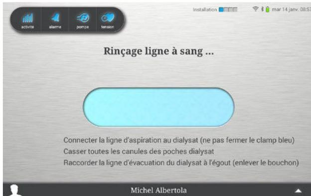
1. Connecter la ligne d'aspiration du dialysat propre de la cassette à la poche de dialysat la plus basse en utilisant si nécessaire un adaptateur (par exemple HF/Luer).
